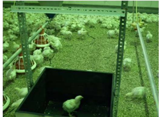
Abb. 6.2: Kiste für die Planimetrie mit einem dunklen Untergrund und Rahmen zur Fixation der Kamera
